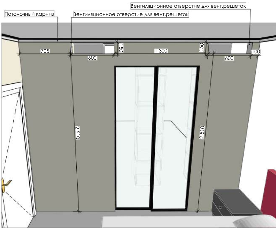
Узел 2. Вентиляционные отверстия в спальне
